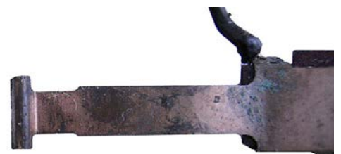
Ein in seine Einzelteile zerlegter Mittelschleifer, bei dem die Bleche infolge Kontaktkorrosion beschädigt sind. Von außen ist dieser Schaden nicht zu erkennen, Strom und Daten werden jedoch nur unzureichend oder gar nicht übertragen. Es empfiehlt sich nicht, Schleifer in dieser Weise zu zerlegen, um „mal nachzuschauen“ – die Chance, die Einzelteile wieder zu einem funktionsfähigen Schleifer zusammen zu bekommen, ist gering..
