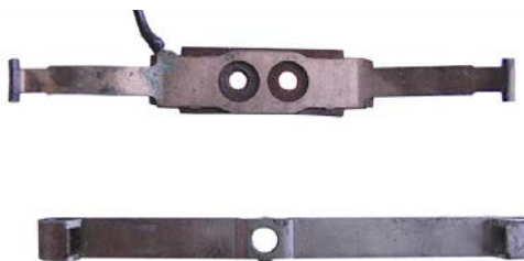
Ein in seine Einzelteile zerlegter Mittelschleifer, bei dem die Bleche infolge Kontaktkorrosion beschädigt sind. Von außen ist dieser Schaden nicht zu erkennen, Strom und Daten werden jedoch nur unzureichend oder gar nicht übertragen. Es empfiehlt sich nicht, Schleifer in dieser Weise zu zerlegen, um „mal nachzuschauen“ – die Chance, die Einzelteile wieder zu einem funktionsfähigen Schleifer zusammen zu bekommen, ist gering..
