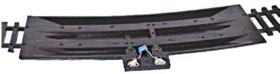
Kleines Bauteil, große Wirkung: Der Entstörkondensator aus analogen Zeiten, der beim Umstieg auf Digital in den Schienen vergessen wurde, stört die Übertragung der digitalen Signale.
