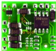
Lokdecoder für Wechselstrommotoren
