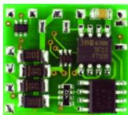
Lokdecoder für Gleichstrommotoren
