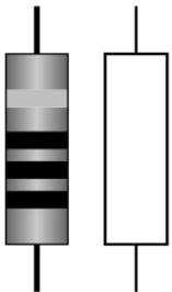
Widerstände "bremsen" den Stromfluss. Ihre Einbaurichtung ist beliebig. Der Wert von Widerständen für kleine Leistungen (unter 0,5 W) wird durch Farbringe dargestellt. Jede Farbe steht dabei für eine andere Ziffer. Die in Klammern angegebene Ringfarbe gibt den Toleranzbereich an, dieser ist hier nicht von Bedeutung.
