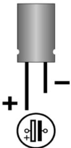
Elektrolyt-Kondensatoren (kurz "Elkos") werden oft zur Speicherung von Energie eingesetzt. Im Gegensatz zu keramischen Kondensatoren sind sie gepolt. Einer der beiden Anschlüsse ist mit einem Minus-Zeichen gekennzeichnet, das die Einbaurichtung vorgibt. Der Wert ist auf dem Gehäuse aufgedruckt.
