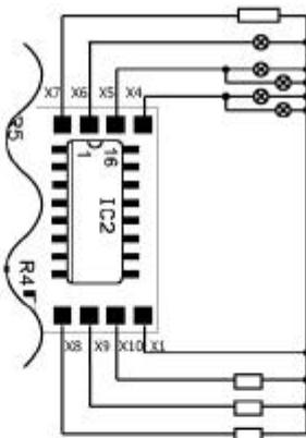
Fig. 1b: Adresseinstellung über Löt pads an X15 / Setting the address via solder bridges
