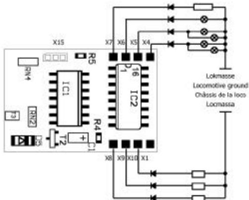
Verbindung des 2. Anschlusses mit Lokmasse
